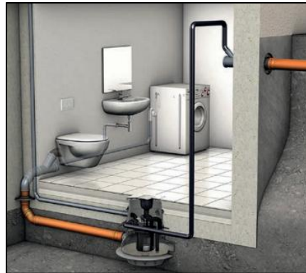
Funktionsprinzip Abwasserhebeanlage und Rückstausicherung Leitfaden Wassersensibles planen und bauen – Steb Köln
